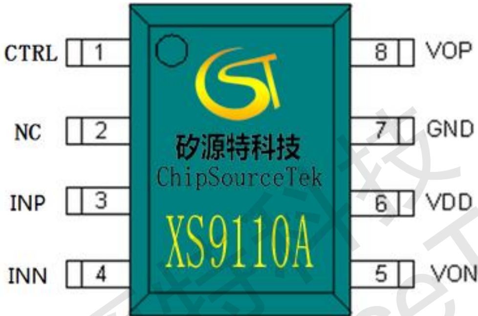
图 2 XS9110A 管脚定义
